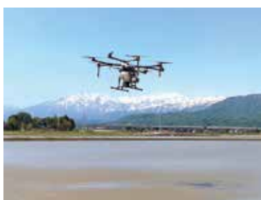
スマート農業（ドローンによる直播の様子）
